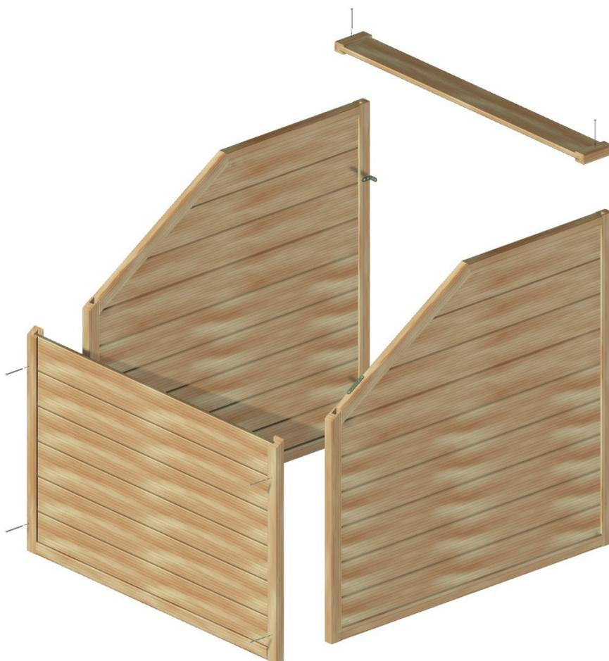
Fixer l'ensemble à la structure en bois de la piscine à l'aide des 4 équerres (8) et de 8 vis 3,5 × 25 (14).
